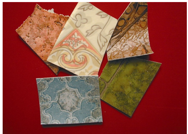
2 Mehrschichtige Bodenbeläge bestehen in der Regel aus PVC mit einer Trägerschicht aus schwach gebundenem Asbest.
