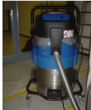
3 Industriestaubsauger mit Filter für Staubklasse H (Asbest)
